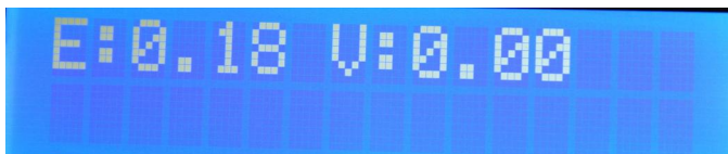
Abbildung 16: Das zweite Übersichtsdisplay. Die Gesamterzeugerleistung aller Erzeugungsanlagen beträgt hier 0,18kW. Die Gesamtverbräuche aller Verbrauchsanlagen beträgt hier 0,0kW. Bei Geräten mit Speicherauswertung wird hier die Ladung und Entladung ebenfalls angezeigt.
