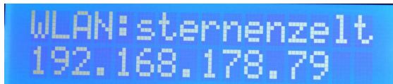
Abbildung 11: Der EVA-LOG hat sich erfolgreich mit dem Netzwerk "sternenzelt" verbunden und ist in diesem unter der Adresse "192.168.178.79" erreichbar. Bei Netzwerknamen mit mehr als 11 Zeichen werden alle ab dem Elften ausgeblendet.
