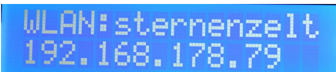
Abbildung 19: Netzwerkeinstellungen. Der EVA-LOG hat sich erfolgreich mit dem Netzwerk "sternenzeit" verbunden und ist in diesem unter der Adresse "192.168.178.79" erreichbar. Bei Netzwerknamen mit mehr als 11 Zeichen werden alle ab dem Elften ausgeblendet.
