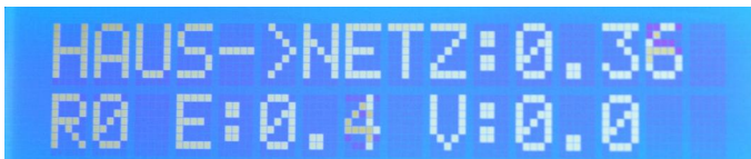
Abbildung 15: Das Übersichtsdisplay. Der Energiefluss vom Haus in das Netz wird mit einer Leistung von 0,36 kW angezeigt. "R0" zeigt, dass die Reduktionsstufe 0 aktiv ist (keine Reduktion). Die Gesamterzeugerleistung aller Erzeugungsanlagen beträgt hier 0,4kW. Die Gesamtverbräuche aller Verbrauchsanlagen beträgt hier 0,0kW. Die Anzeigen der Gesamtleistungen werden hier zur Übersicht auf 1 Stelle hinter dem Komma begrenzt.
